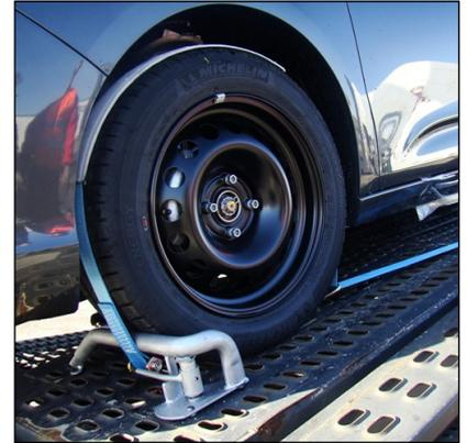
Los vehículos cargados en la parte trasera en posición inclinada deberán sujetarse con dos calzos y un cinturón de amarre adicional. Para más información sobre la sujeción en vehículos plataforma y características técnicas contacte con nosotros.
