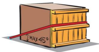
dirección, que suele ser hacia delante o hacia atrás. Se trata de un único amarre que parte de un punto en el lateral del vehículo, pasa por delante (o por detrás) de la carga y se fija a otro punto de amarre situado en el lateral opuesto, de forma que quede enfrente o casi enfrente del primero. Se utilizan diferentes variantes de la sujeción con resorte para evitar que los amarres se deslicen hacia abajo:
