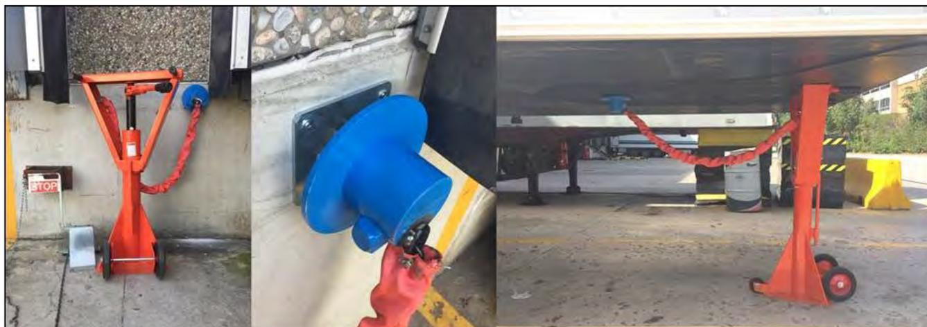
El sistema se puede instalar en cualquier modelo de caballete o soporte para tráiler.
