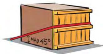
opuesto, de forma que quede enfrente o casi enfrente del primero. Se utilizan diferentes variantes de la sujeción con resorte para evitar que los amarres se deslicen hacia abajo:
